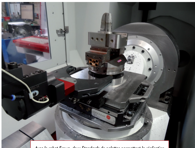
Avec le robot Erowa, deux Standards de palettes permettent la réalisation d'une grande diversité de pièces de tailles différentes.
